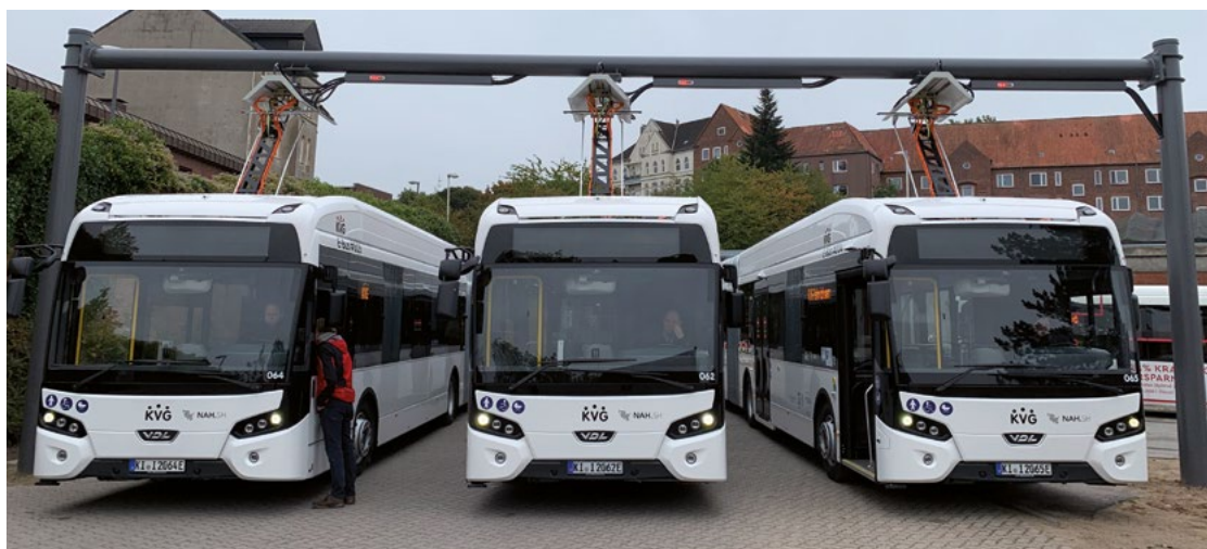
Abbildung 13: Elektrobuse in Kiel beim Schnellladen über Pantograph-Ladestationen, Quelle: KVG Kieler Verkehrsgesellschaft mbH
