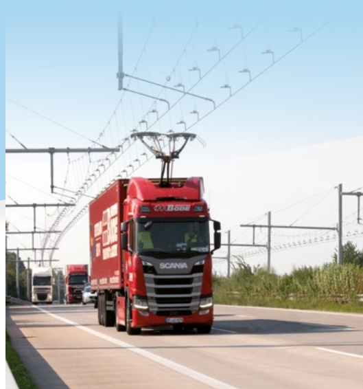
Abbildung 7: Elektrischer Lastkraftwagen fährt auf der Autobahn, während er Strom aus der Oberleitung bezieht, Quelle: FuE-Zentrum FH Kiel GmbH
